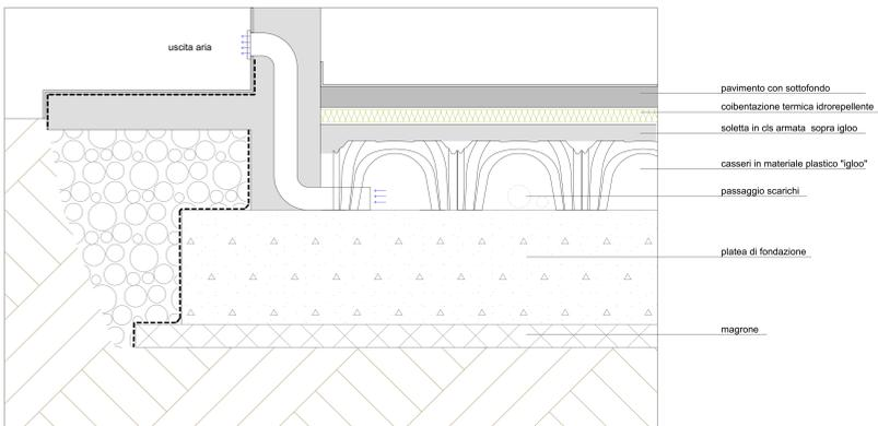
PARTICOLARE AEREAZIONE SOLAIO PIANO TERRA 1:10
