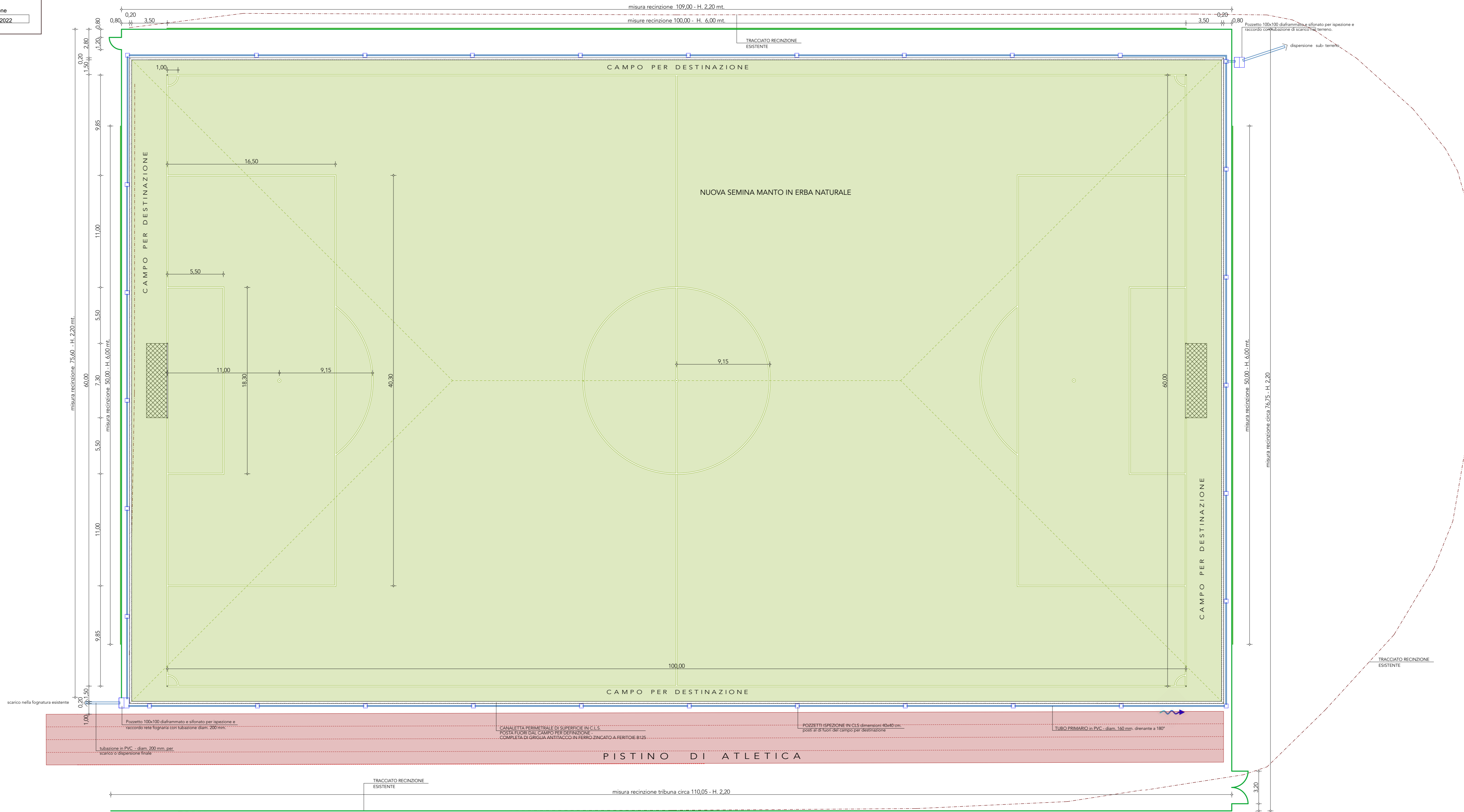
PLANIMETRIA SCHEMA TRACCIATURA CAMPO DI GIOCO dimensioni 100 x 60 - RECINZIONE - 1:200
